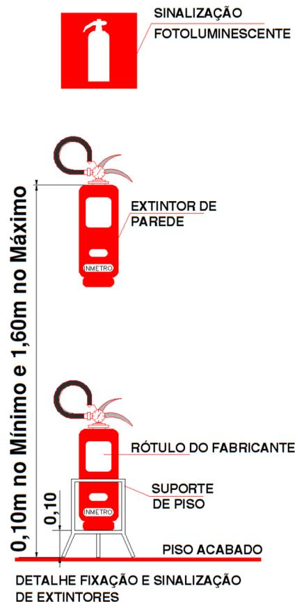
Figura 1. Fixação de extintor
